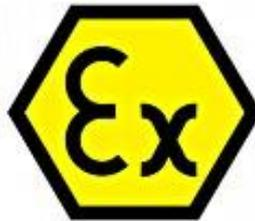
Questa marcatura contiene tutte le indicazioni necessarie per determinare le zone di utilizzo possibili. E quindi oltre alla marcatura CE e ai dati per identificare il prodotto quali il nome del costruttore, il riferimento di tipo, la serie e alcuni parametri elettrici, un'apparecchiatura conforme alle norme ATEX deve necessariamente riportare il simbolo visto in fig.5.
