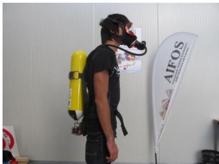
L'apparecchio permette all'utente di essere alimentato "a domanda" di aria respirabile proveniente dalla bombola (esempio in fig.10). Un altro sistema è l'elettrorespiratore a presa d'aria esterna cioè respiratori ad aria compressa a flusso continuo (esempio in fig.11), alimentati dal esterno. In commercio si trovano più soluzioni per questa tipologia di DPI, che comunque vanno scelti in base ai pericoli presenti e in base a tutte le difficoltà che lo spazio stesso presenta.
